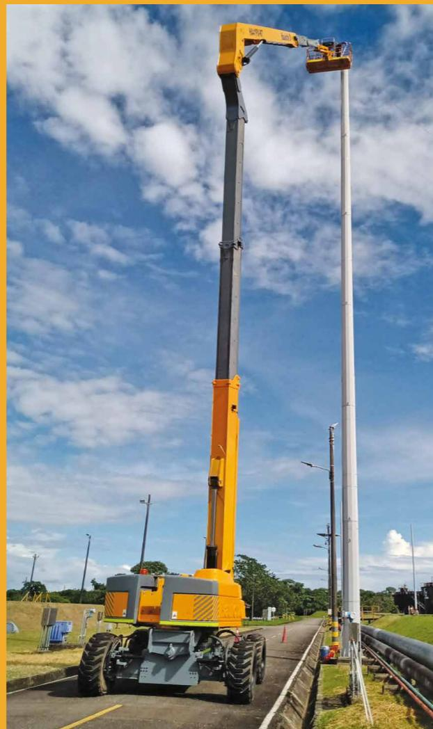
Plataformas elevadoras versátiles que permiten el acceso rápido y seguro a zonas de trabajo elevadas. Ideales para mantenimiento, instalación y trabajos eléctricos.
