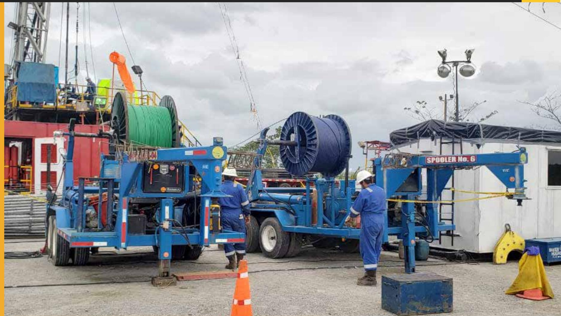
Equipos para manipulación, desenrollado y enrollado de cables eléctricos, tuberías flexibles y otros elementos lineales. Clave en proyectos de energía y telecomunicaciones.
